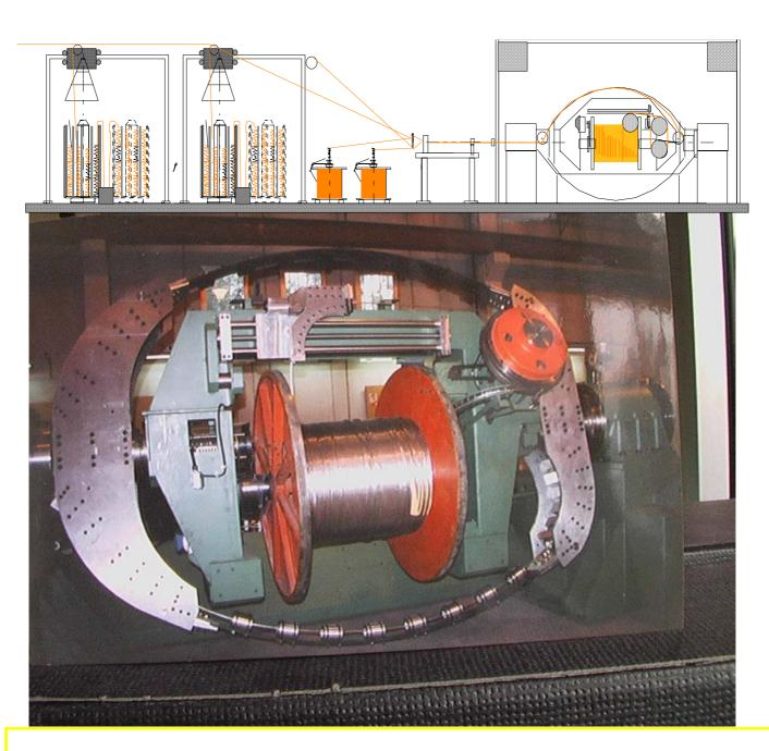
Машина с тяговыми шайбами, где скручиваемый продукт продвигается кабестанами.
